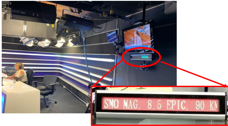
Display EWBS en funcionamiento En una estación de radio en Lima, Perú
